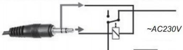
Mikro-prijenos dizajniran za izmjenu vanjskih električnih kontakata
